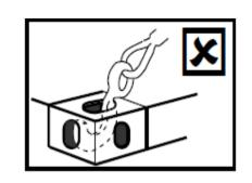
5.2.12 為防貨櫃摺曲,鋁質貨櫃或異常重的貨櫃應以合適的起 吊設備起吊,而該起吊設備只施加垂直力予貨櫃全部四 個夾角接頭。
