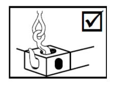
5.2.11 如果貨櫃有可能卡在槽軌內,便不應使用帶鈎吊索經過槽軌把貨櫃起吊或降下,而應使用適當設備,例如排架或裝有特製吊頭的吊索等。切勿試圖把吊鈎楔入夾角接頭來起吊貨櫃,這是不當的做法。
