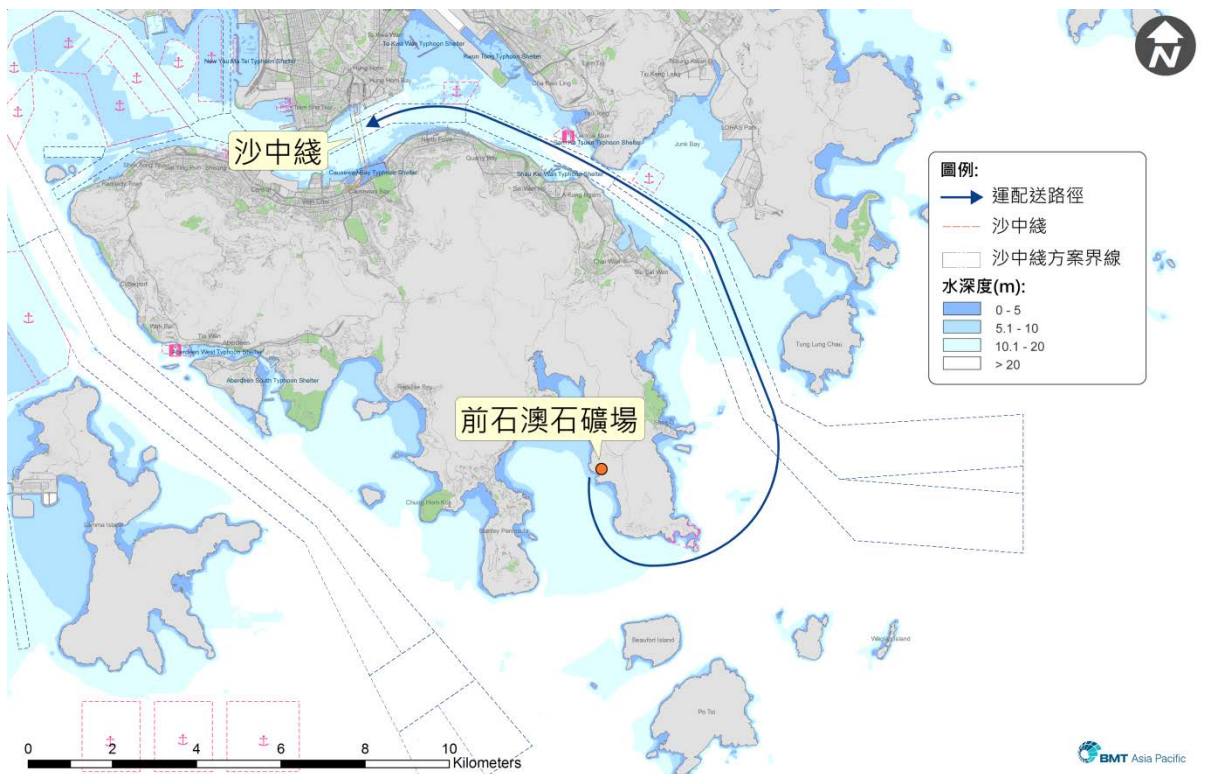
圖 2：沉管隧道預製件的運送路徑
