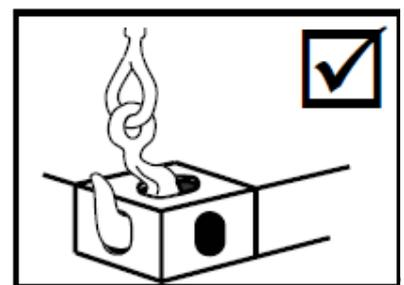
5.2.911 如果貨櫃有可能卡在槽軌內，便不應使用帶着鈎吊索經過槽軌把貨櫃起吊或降下，而應使用適當設備，例如排架或裝有特製吊頭的吊索等。切勿試圖把吊鈎楔入夾角接頭來起吊貨櫃，這是不當的做法。
