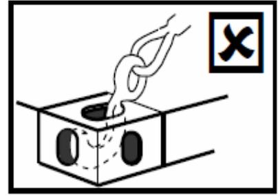
5.2.102 為防貨櫃摺曲，鋁質貨櫃或異常重的貨櫃應以合適的起吊設備起吊，而該起吊設備只施加垂直力予貨櫃全部四個夾角接頭。
