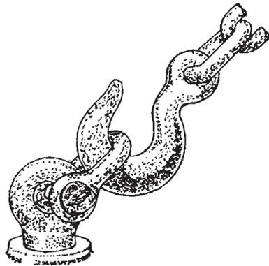
圖五、（具接環的）「領圈」式環首螺栓
