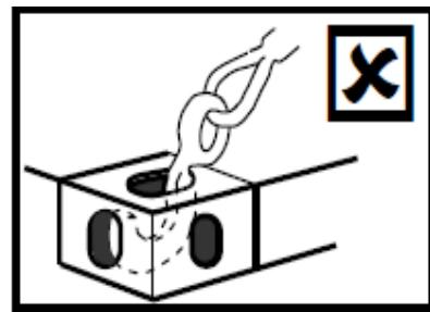
5.2.12 为防货柜摺曲，铝质货柜或异常重的货柜应以合适的起吊设备起吊，而该起吊设备只施加垂直力予货柜全部四个夹角接头。
