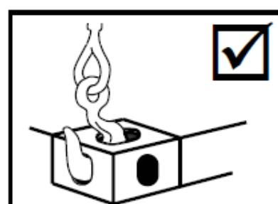
5.2.11 如果货柜有可能卡在槽轨内，便不应使用带钩吊索经过槽轨把货柜起吊或降下，而应使用适当设备，例如排架或装有特制吊头的吊索等。切勿试图把吊钩楔入夹角接头来起吊货柜，这是不当的做法。
