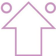
此符號表示航道走向，香港是根據水大流的方向而決定。當船隻順航標方向行駛時，綠色的右側航標必須在船之右舷經過。當船隻反航標方向行駛時，紅色的左側航標必須在船之右舷經過。當船隻由東面鯉魚門入港時，應將紅色的左側浮標放在船隻的左舷經過、綠色的右側航標放在船隻的右舷經過。
