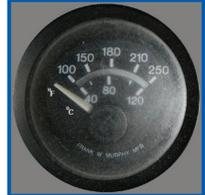
如果冷卻水溫日漸升高，表示冷卻系統需要維修保養，例如清洗過濾器、熱交換器和暢通管道等定期維護工作。
