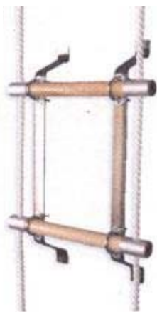
圖 8 - 繩梯設有支架，可提供足夠空間（最少 115 毫米）作為立足處。
