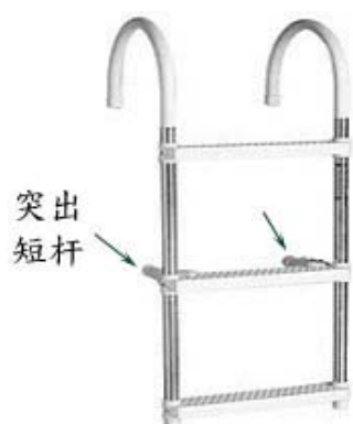
圖 7 - 活動扶梯設有兩條突出短杆，可提供足夠空間（最少 115 毫米）作為立足處。
