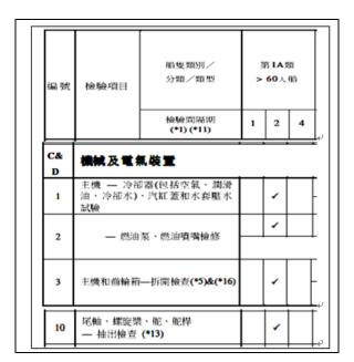
映,部份船只的主机和齿轮箱虽然到期检验,但运行时间仍远未达到制造商建议的大修(即拆开维修及检验)间隔时间,而尾轴、螺旋桨、舵和舵杆亦少有严重损耗。此外,部份船只的主机和齿轮箱在到期检验前因其他原因已进行大修或更新,但却因应工作守则的要求而仍须在定期验船时重新拆开检验,增加额外运作成本。业界认为处方应考虑让主机、齿轮箱和尾轴等检验项目的间隔期可适当地延长。
