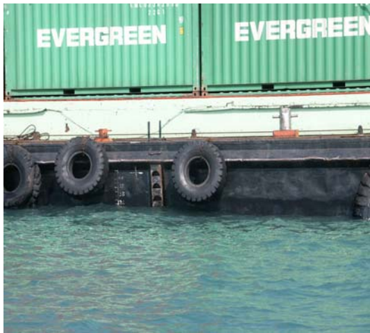
Photo 10 – Fixed ladders on dumb steel lighters 圖10—非自航鋼躉上的固定梯
