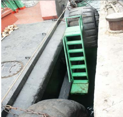
Photo 10 – Fixed ladders on dumb steel lighters 圖10—非自航鋼躉上的固定梯
